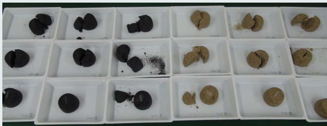
強度試験後の試験体
